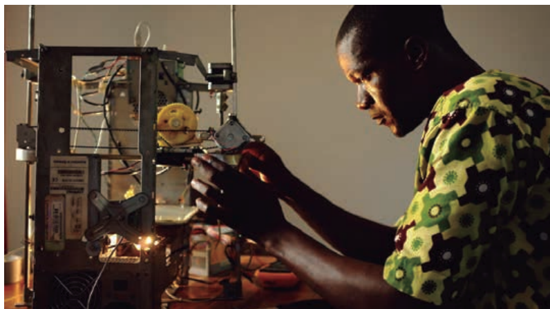
Impressora 3D feita com lixo eletrônico na África (Foto por: Daniel Hayduk)
