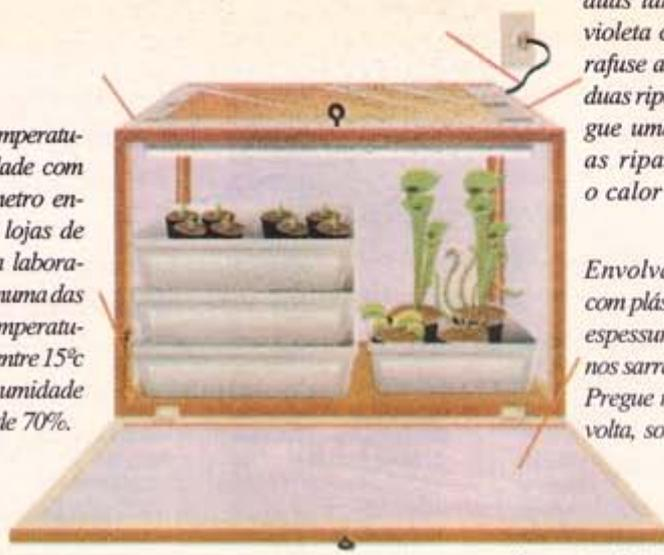
Envolve a estrutura com plástico de 2mm de espessura, pregando-a nos sarrafos. Pregue ripas em toda a volta, sobre o plástico.
